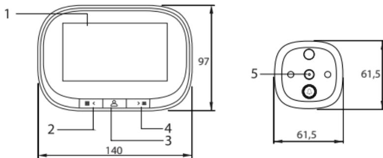
1. Wyświetlacz LCD      2. Lewy przycisk      3. Uruchom/zatwierdź
